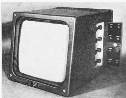
Bei Telefunken um 1942 gebauter Empfänger für Kabelfernsehen mit der ersten in Europa entwickelten 41-cm-Rechteck-Bildröhre. Der Empfänger E 9 hatte ein technisch interessantes Vertikalchassis und war mit Spezialröhren, darunter den Typen LV 3, LG 3 und LG 4, bestückt. Das Gerät wurde u. a. zur Beobachtung der Raketen-Versuchsabschüsse in Peenemünde verwendet
